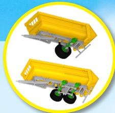
Tren de rodaje atornillado desplazable
